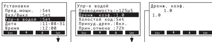
В появившемся диалоге модификации установите коэффициент слива в соответствии с производительностью парообразования.
