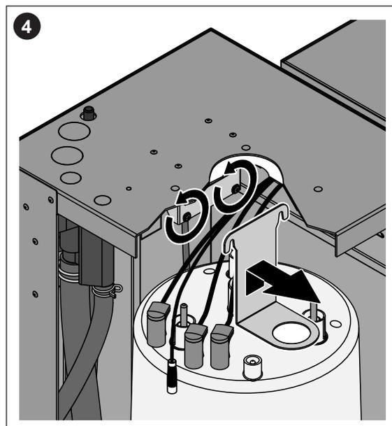
3. Снять вилки кабелей к электродам и датчику.
